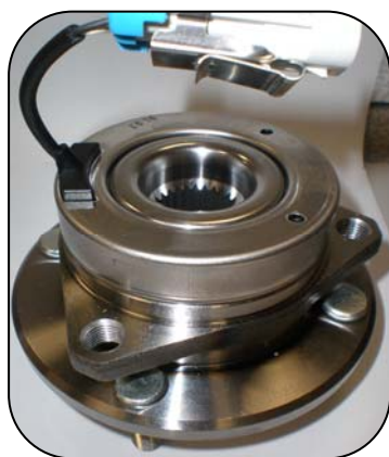
Конструкция 1 типа Совпадает с VKBA 3937
