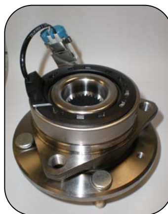
Конструкция 2 типа НЕ совпадает с VKBA 3937
