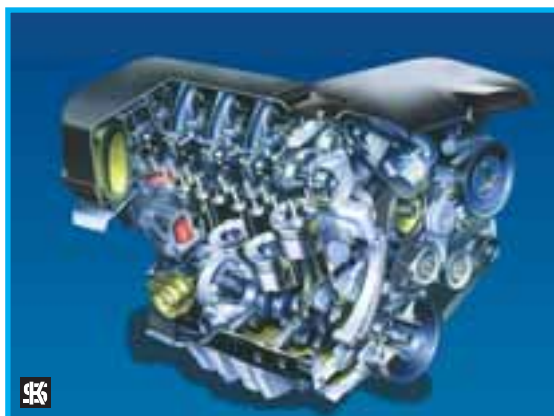
Разрез двигателя внутреннего сгорания
