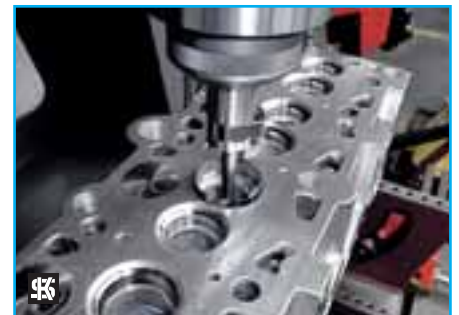
фото 7 Оставшаяся стенка старого кольца седла клапана
