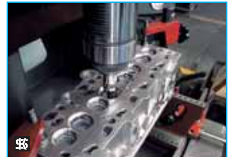
фото 6 Удалить отработанное кольцо седла клапана
